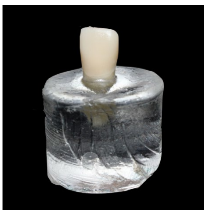
Figura 1: Espécime embutido em resina epóxi para ensaio mecânico.
