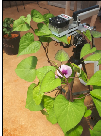
Figura 4: Medida pontual de trocas gasosas em folhas de batata-doce realizada através de um analisador de gases por infra-vermelho (IRGA, Li-6400XTR, LiCor, EUA).
