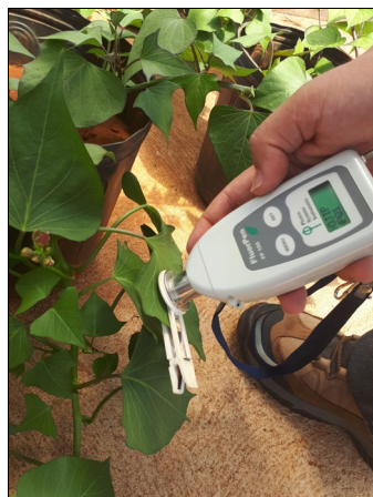
Figura 5: Avaliação da atividade fotoquímica por meio da análise de fluorescência da clorofila a , utilizando um medidor óptico de fluorescência (FluorPen, FP100, Photo System Instruments).
