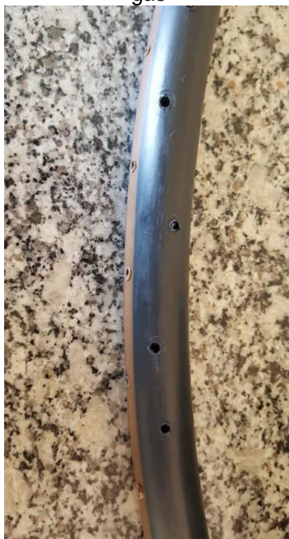
Figura 2 – Mangueira perfurada para captação de gás
