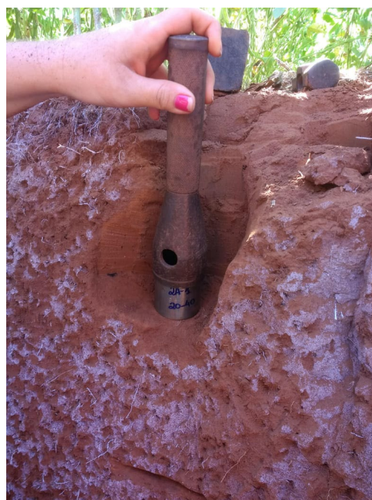
Figura 6. Castelinho de ferro e anel de inox para retirada de amostra indeformada de solo.
