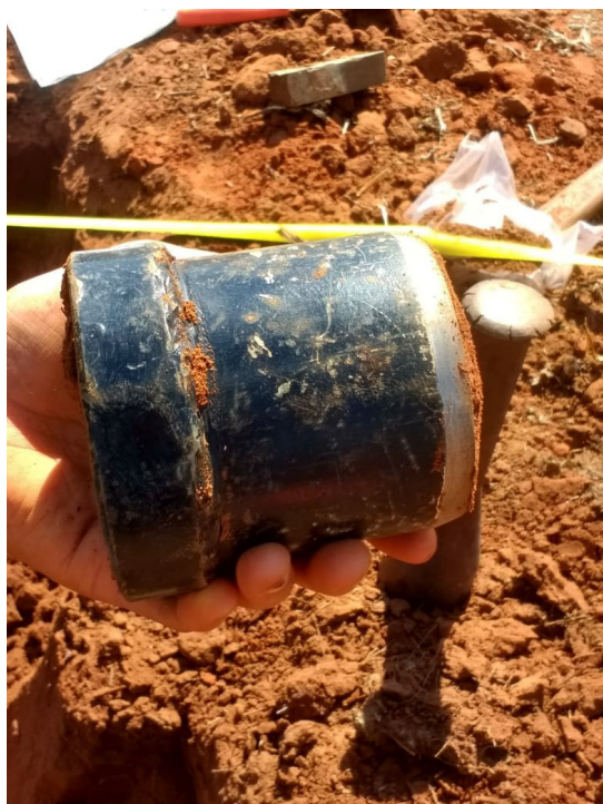
Figura 5. Monolito de ferro com tamanho de 10x10x10 cm (AxLxC).
