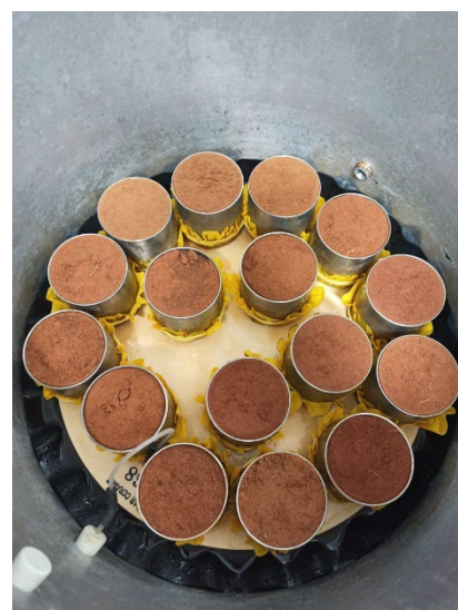
Figura 13. Amostras indeformadas sob placa porosa de Richard.
