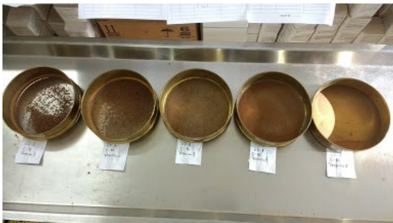
Figura 11. Peneiras do tamisador para separação de agregados em 5 classes de tamanhos
