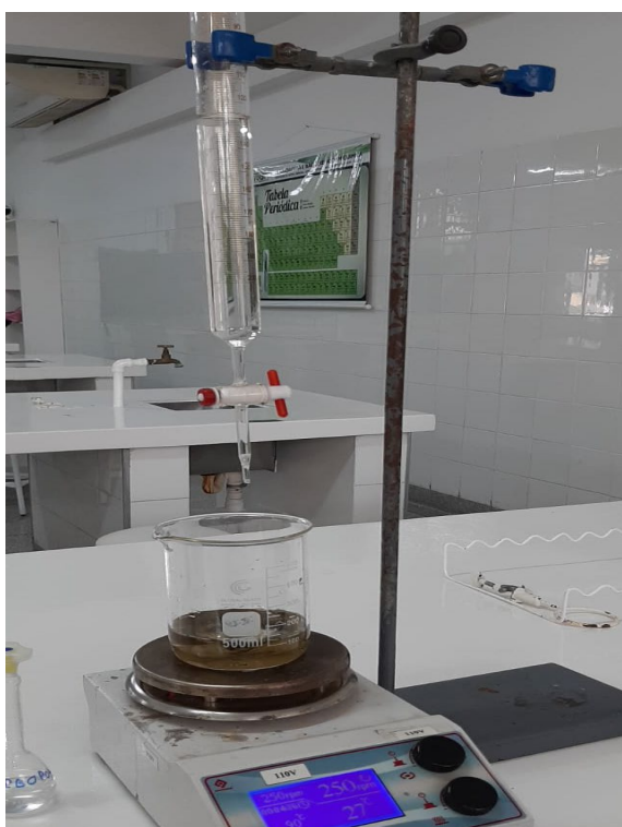
Figura 1 - Síntese de nanopartículas de prata (NP Ag ) - \text{AgNO}_3 adicionado à solução de \text{NaBH}_4 gota a gota, sob agitação a 200 rpm
