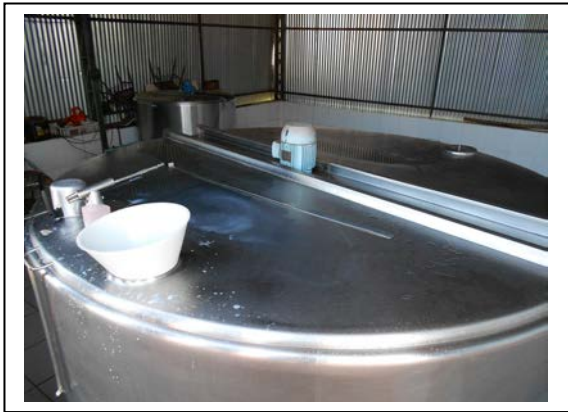
FIGURA 6 – Tanque resfriador com capacidade para 6000 litros Fonte: Pesquisa de Campo (10/10/2012) Autora: Santos, Eliane Silva dos
