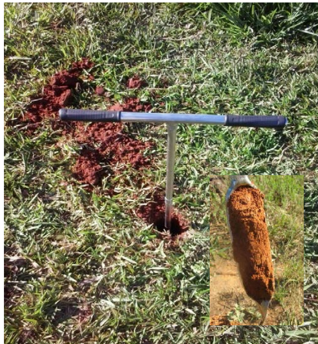
FIGURA – 8 Coleta de amostra com trado holandês
