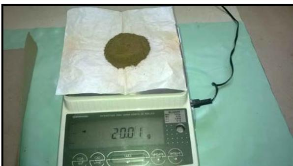
**Figura 11.** Obtenção da massa de solo deformado e seco.
