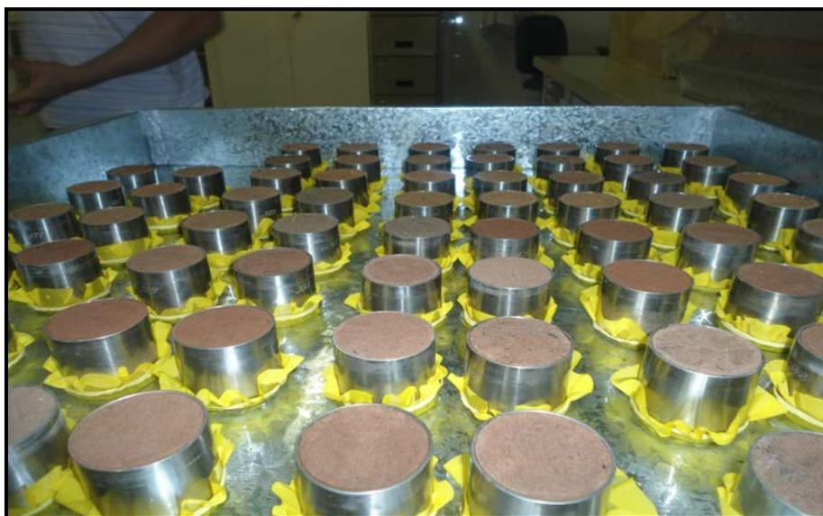
**Figura 15.** Vista das amostras indeformadas preparadas para o procedimento de saturação em água.
