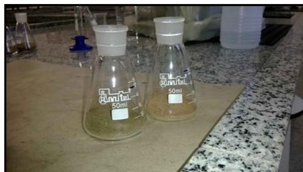
**Figura 12.** Erlenmeyer, de 50 mL com solo e pronto para a determinação.
