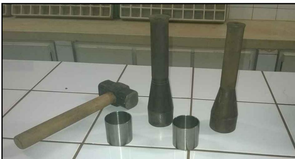
**Figura 10.** Instrumentos utilizados na coleta das amostras indeformadas: marreta, amostrador tipo Uhland e cilindros de aço inox.
