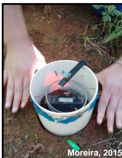
Figura 8. Detalhe do procedimento de instalação do coletor de \text{N-NH}_3
