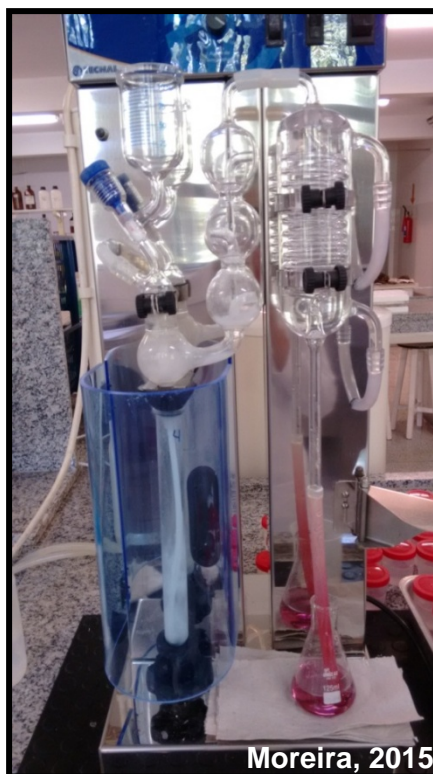
Figura 7. Destilador de Kjeldhal
