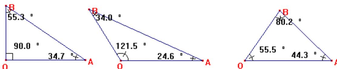
FIGURA 11: T3 - Classificação de triângulos em relação aos ângulos
