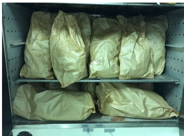
Figura 20. Secagem na estufa (24 horas / 60°C)
