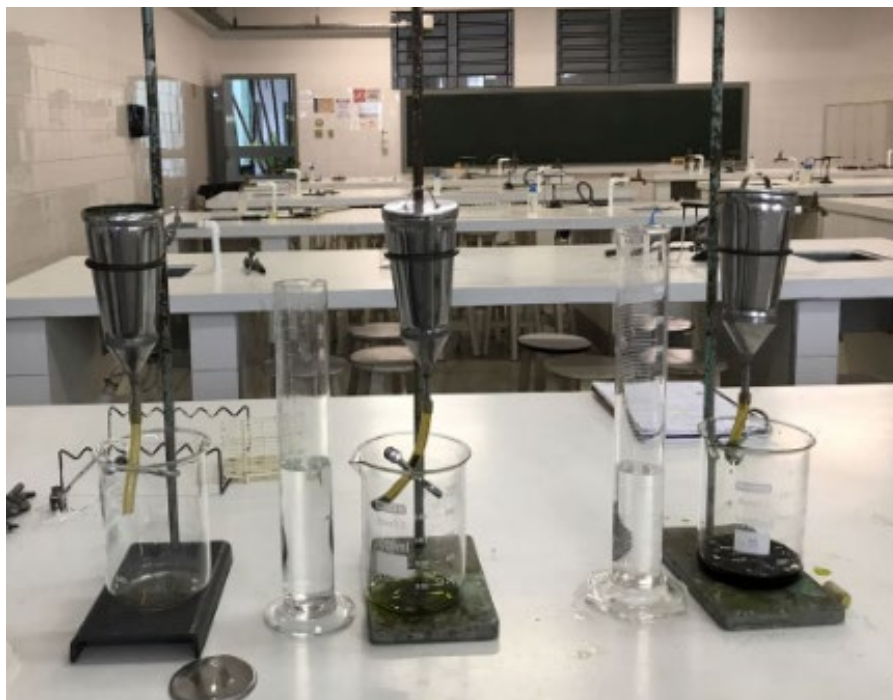
Figura 22. Percolação do material moído para obtenção do extrato etanólico.
