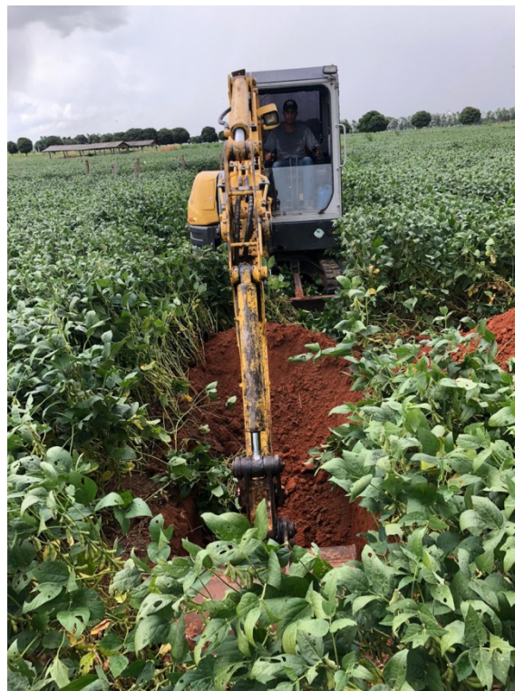
FIGURA 26 - Abertura de trincheira durante a soja para coleta de amostras de solo
