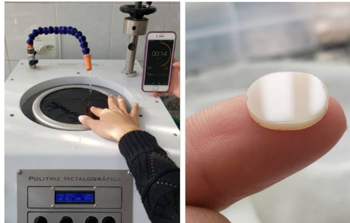
Figura 3. Etapa de acabamento das faces planas dos discos de cerâmica.
