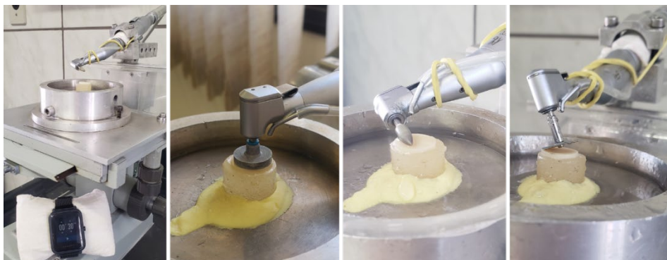
Figura 6. Polimento dos discos de cerâmica.
