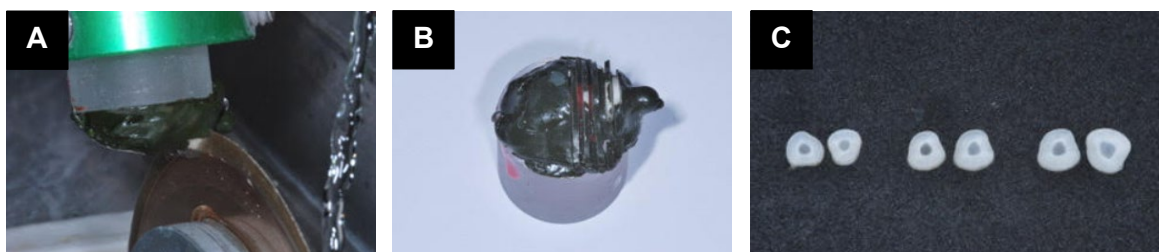
Figura 13 - A) Seccionamento das raízes em terços; B) Cortes realizados; C) Fatias obtidas. (Fonte: arquivo pessoal)
