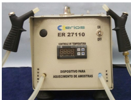
Figura 10 - Equipamento usado para volatilização do sistema adesivo nas temperaturas de 23 e 40°C. (Fonte: arquivo pessoal)
