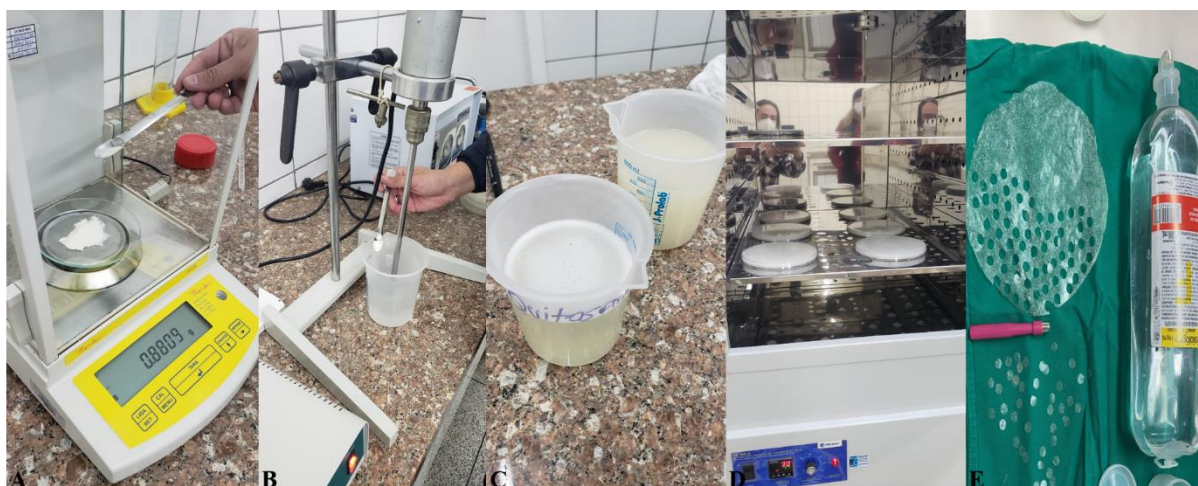
Figura 5. Processamento da membrana. A: pesagem do material; B: diluição e homogeneização; C: preparo pronto; D: fracionamento em placas de Petri e secagem em estufa; E: membrana pronta para ser hidratada e utilizada nas lesões.
