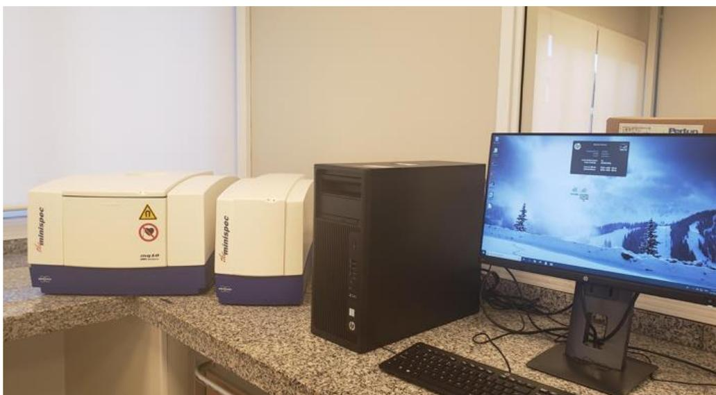
Figura 20. Equipamento Minispec TD-NMR Mq10, instalado na Planta Experimental da Bayer de Uberlândia – MG.
