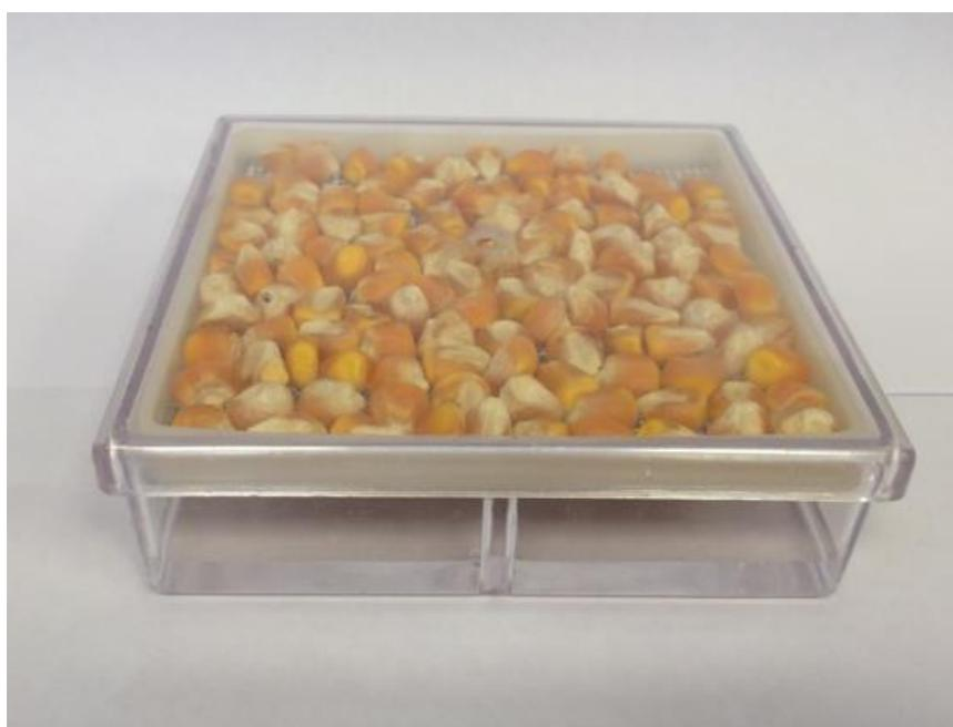
Figura 5. Exemplo de caixa montada para projeto piloto de câmara úmida com solução de sulfato de potássio.
