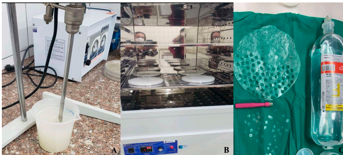
Figura 4.: A-B: preparação da membrana. C: membrana cortada com punch 8mm e pronta para ser reidratada com solução fisiológica.
