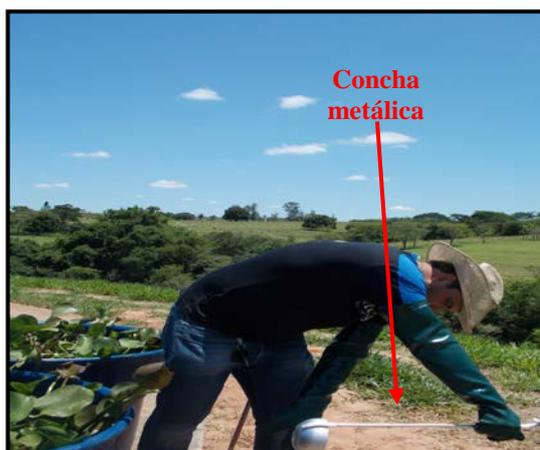
**FIGURA 27.** Coleta das amostras dos tratamentos com auxílio de uma concha de alumínio
