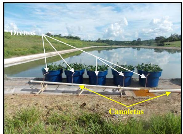
**FIGURA 08.** Drenos ( $\frac{1}{2}$  polegada), canaletas ( $2\frac{1}{2}$  polegadas) ligado as caixas coletoras externas
