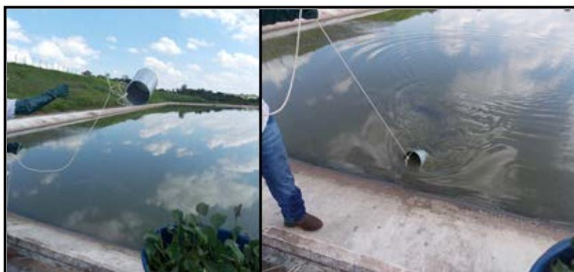
**FIGURA 33.** Coleta do efluente na lagoa com auxílio de balde e corda para reposição do efluente (quando necessário)
