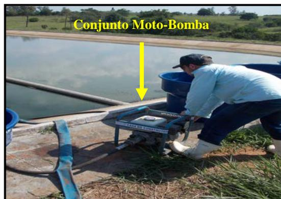
**FIGURA 18.** Conjunto moto bomba para captação de efluente
