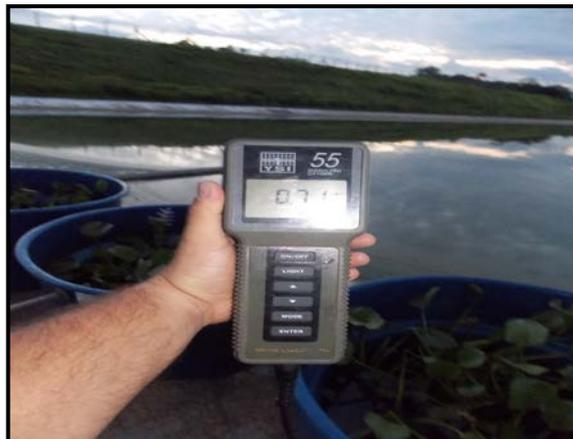
**FIGURA 32.** Oxímetro utilizado para leitura de oxigênio dissolvido e temperatura do efluente
