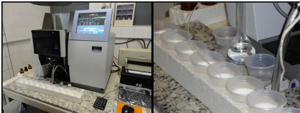
**Figura 16.** Espectrofotômetro de absorção atômica modelo AA200, PerkinElmer, utilizado para a quantificação do K total
