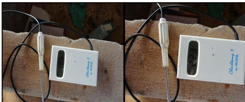
**Figura 8.** Detalhes do termômetro digital com haste metálica
