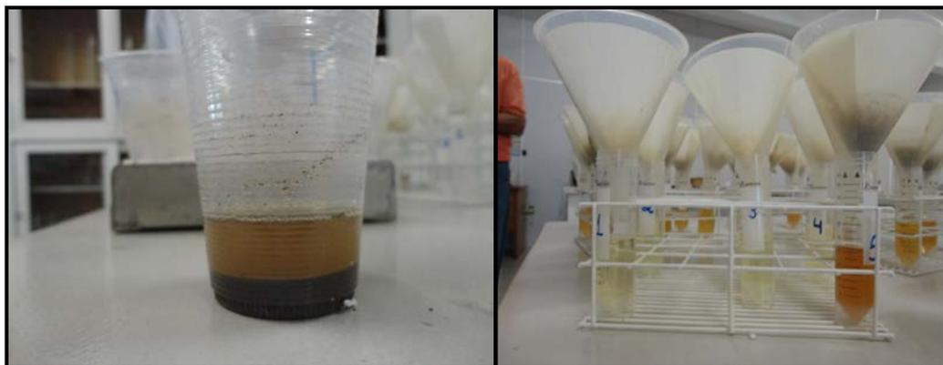
**Figura 11.** Amostras antes e depois da filtração para determinação da Ce
