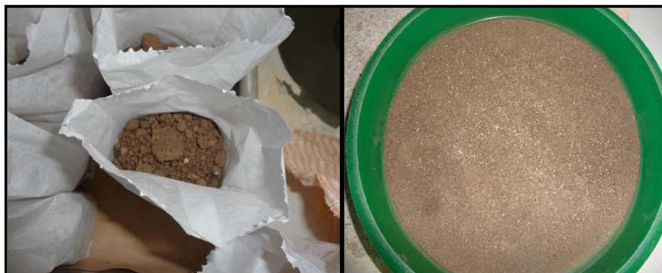
**Figura 10.** Material antes e depois da moagem destinado para análise química
