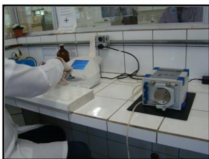
**Figura 20.** Espectrofotômetro de UV-Vis
