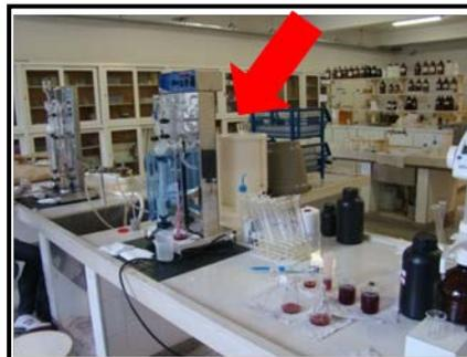
**Figura 19.** Destilador Kjeldahl
