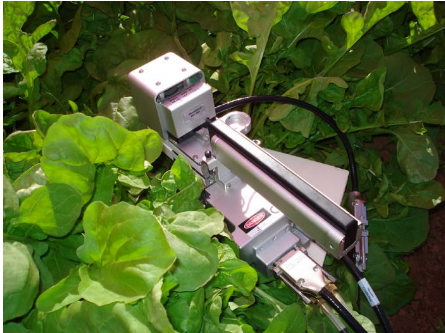
FIGURA 3 – Medição de trocas gasosas da rúcula cultivada sob telas fotoconversoras por infra-vermelho (LI-6400).
