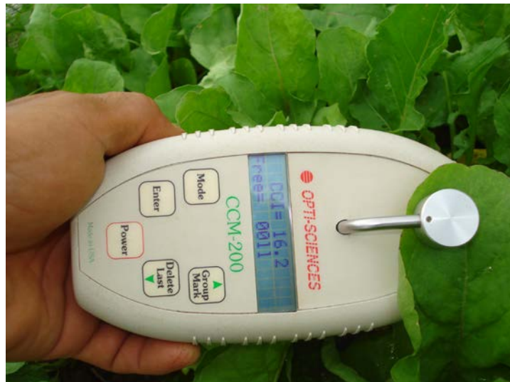
FIGURA 4 – Medição do teor de clorofila em folhas de rúcula cultivadas sob telas fotoconversoras com clorofilômetro CCM-200.
